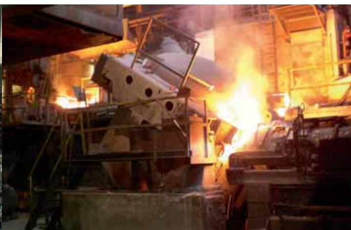
Plahfertigung im Schlegelgussverfahren aus flüssigem Eisen
